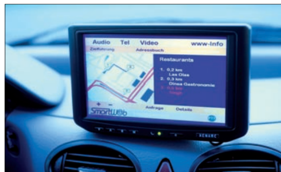
Bild 3. Navigationsgeräte benötigen oft spezielle 3D-Beschleuniger-Hardware – ein Hindernis für den Einsatz von Virtualisierungstechnologien.
